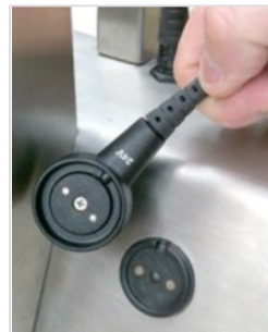
Leveres altid med 24 Volt lader. Ladecontakterne er magnetiske og kan ikke places forkert .
